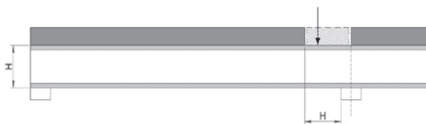
Figure 34 – Zones de réductions des charges contribuant à l'effort tranchant
