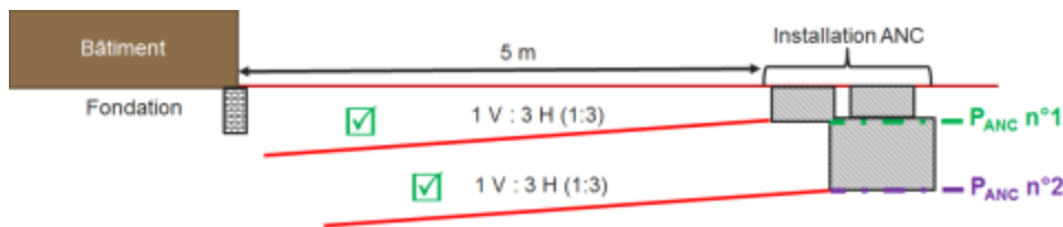
Figure 7 : Distance dispositif d'ANC vis-à-vis des fondations – impact hydraulique (vue en coupe).
