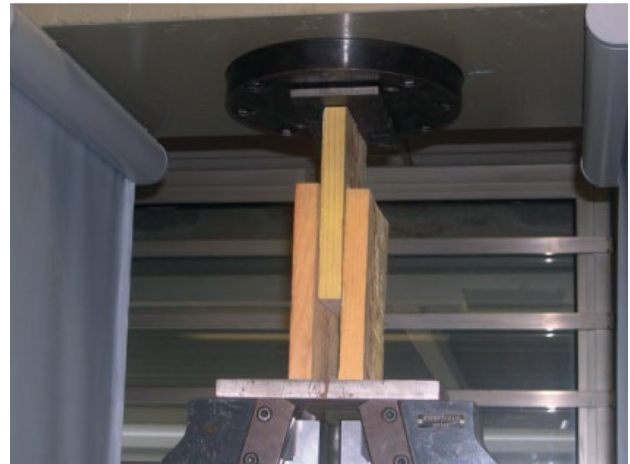
Figure 48 – Dispositif d'essai de caractérisation des organes d'assemblage de panneaux massifs cloués
