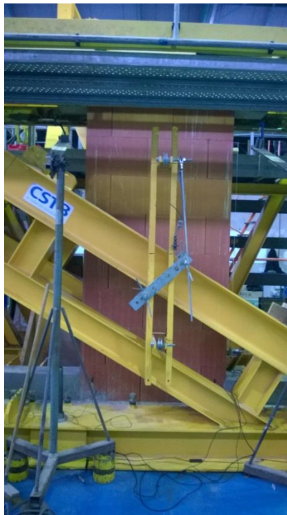
Figure 5 Exemple d'essai de contreventement sur trumeau
