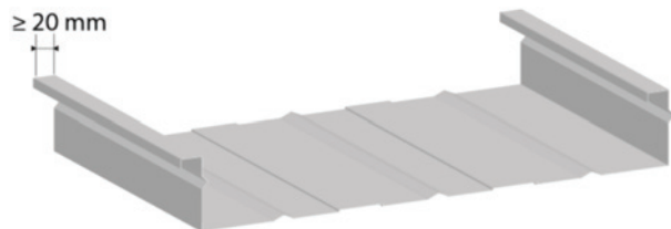
Figure 2 – Exemple de plateau de bardage. Retour de largeur minimum 20 mm
