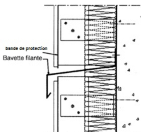
Figure 28b– Compartimentage horizontal de la lame d'air
