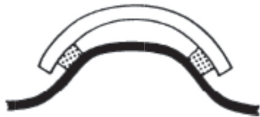
Figure 7 – Fixation par plots de collage
