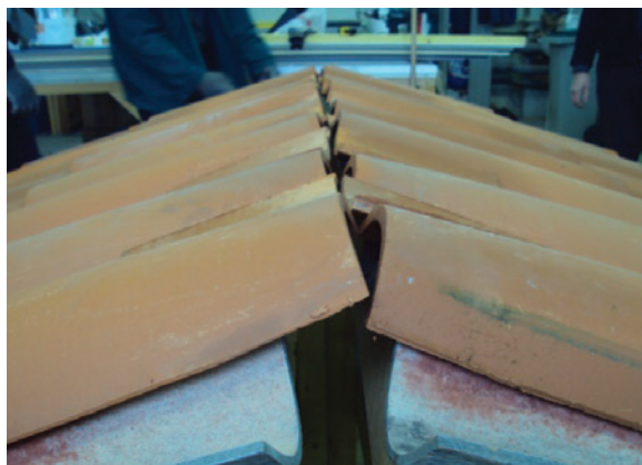
Pose des tuiles sur la plaque
