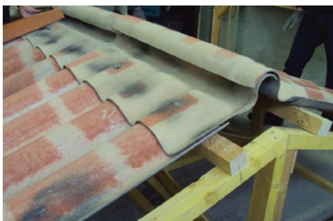
Les éléments P et G sont fixés sur les pannes
