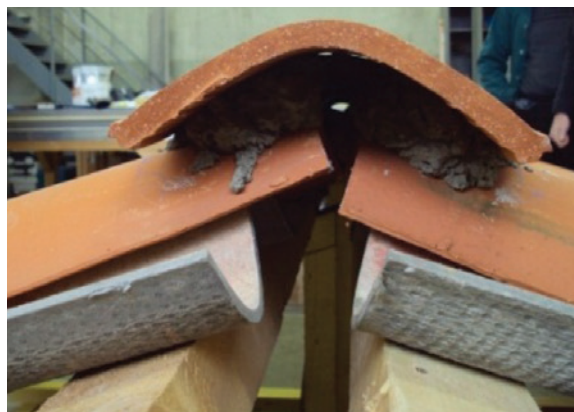
Ventilation au faîtage par les pignons (cas 1 et cas 2)
