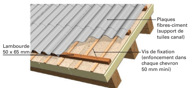
Figure 3 – Pose sur panneaux sandwich
